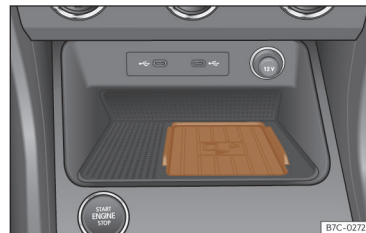
Fig. 156 En la consola central: alojamiento para la conexión del teléfono móvil.
