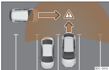
Fig. 143 Representación esquemática del asistente de desaparcamiento: zona vigilada alrededor del vehículo que está desaparcando.
