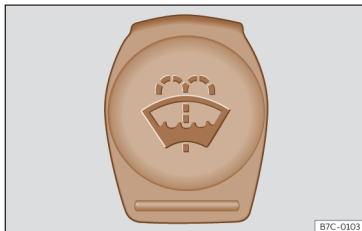
Fig. 196 En el vano motor: tapón de color azul del depósito del limpiacristales.
