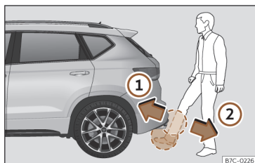
Fig. 57 Portón del maletero con apertura controlada por sensor (Easy Open).
