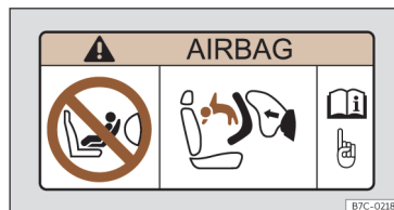
Fig. 33 Adhesivo del airbag: en el parasol del lado del acompañante.
