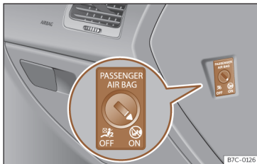
Fig. 25 Conmutador con llave para activar y desactivar el airbag del acompañante.
