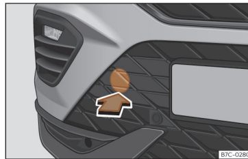
Fig. 183 En el lado derecho del paragolpes delantero: retirar la tapa.
