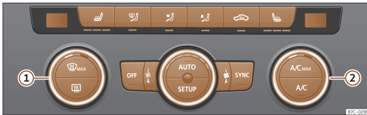
Fig. 86 En la consola central: mandos del Climatronic.
