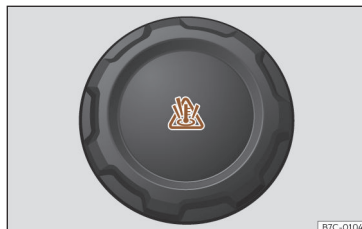
Fig. 194 Vano delantero: tapón del depósito de expansión del líquido refrigerante.
