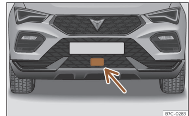
Fig. 101 En el paragolpes delantero: sensor de radar.
