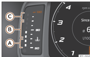
Fig. 4 Indicador de temperatura del líquido refrigerante del motor.
