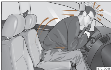
Fig. 17 El conductor que no lleve puesto el cinturón de seguridad se verá proyectado hacia delante.
