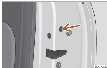
Fig. 52 Bloqueo de emergencia de la puerta.
