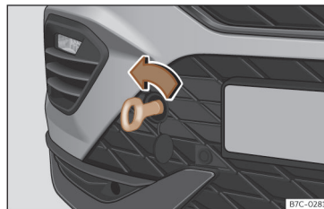
Fig. 184 Parte derecha del parachoques delantero: argolla de remolque enroscada.
