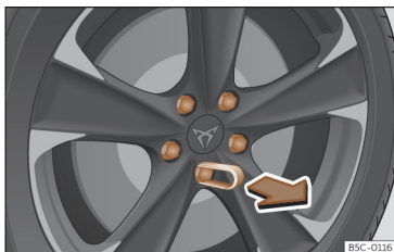
Fig. 207 Rueda: tornillos de la rueda con capuchones.
