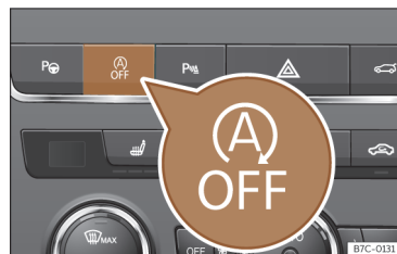
Fig. 91 Consola central: tecla del sistema Start-Stop.
