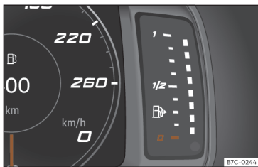
Fig. 3 Indicador del nivel de combustible.
